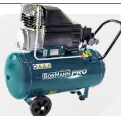
BAT5020 030799 ΑΕΡΟΣΥΜΠΙΕΣΤΗΣ ΜΟΝΟΒΛΟΚ ΜΕ ΛΑΔΙ • Ισχύς 2.5Hp • Παροχή 239Lt/min • Χωρητικότητα 24Lt • Πίεση 10Bar • Βάρος 25Kg
