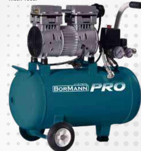
BAT5080 030850 ΑΕΡΟΣΥΜΠΙΕΣΤΗΣ OIL-LESS • Ισχύς 0.75Hp • Παροχή 113Lt/min • Χωρητικότητα 25Lt • Πίεση 8bar
