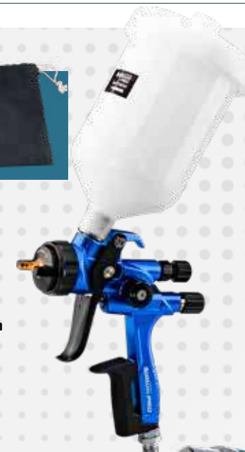
BAT1300 034926 ΠΙΣΤΟΛΙ ΒΑΦΗΣ HVLP • Ακροφύσιο 1.3mm • Δοχείο 600ml • Κατανάλωση Αέρα 380Lt/min • Απόσταση Βαφής 10-15cm
