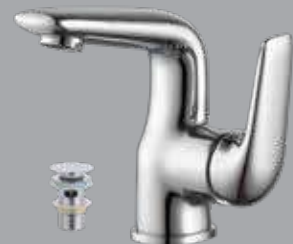
BTW5020 032595 ΜΠΑΤΑΡΙΑ ΝΙΠΤΗΡΑ FLUID ΑΝΑΜΕΙΚΤΙΚΗ • Ορειχάλκινο Σώμα • Κεραμικός Μηχανισμός 35mm • Βάρος 960g • Ύψος 14cm • Ανοξείδωτο Pop-Up
