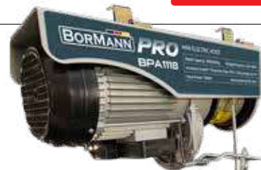
BRA1118 • Ισχύς 1600W • Μέγιστο βάρος ανύψωσης μονός γάντζος 500Kg, διπλός γάντζος 1000Kg • Μέγιστο ύψος ανύψωσης μονός γάντζος 18m, διπλός γάντζος 9m • Βαθμός προστασίας IP54 • Θερμικός διακόπτης • Διακόπτης ασφαλείας • Διάμετρος συρματοσχοινίου Ø6mm
