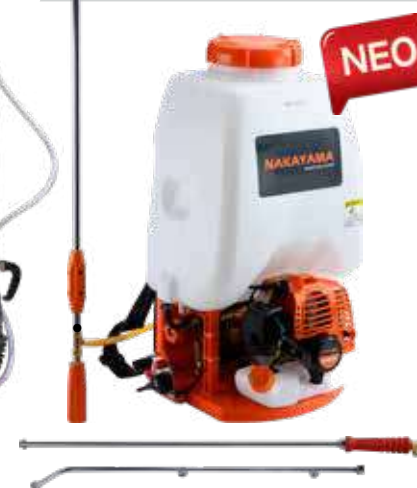
N52635 032854 ΨΕΚΑΣΤΗΡΑΣ ΠΛΑΤΗΣ ΔΙΧΡΟΝΟΣ • Κυβισμός 26cc • Δοχείο υγρών 25lt • Αυλός τριπλού μπέκ με προέκταση και αυλός βιδωτός 60cm • Μέγιστη πίεση 25Bar • Μέγιστη παροχή 8Lt/m • Βάρος 10Kg
